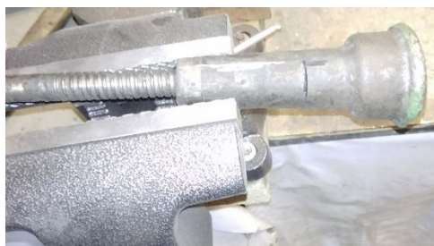
Рис. 4. Фиксация разрезанных частей гайки в тисках
