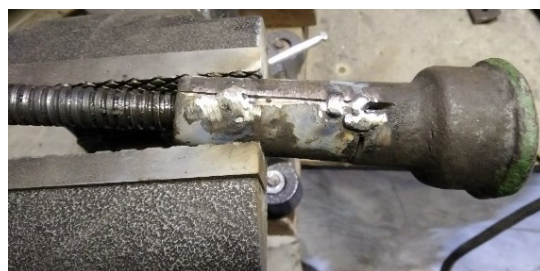
Рис. 4. Фиксация разрезанных частей гайки в тисках
